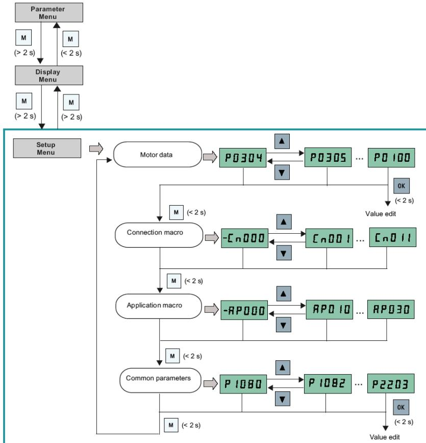
بر طبق این فلوچارت، ابتدا اطلاعات موتور را وارد کنید، سپس مرجع فرمان و سرعت و نوع wiring را در قسمت Connection تنظیم نمایید، نوع کاربرد درایو، در قسمت Application انتخاب می‌گردد و سایر پارامترهای مورد نیاز، در بخش Common Parameter وارد شود.
