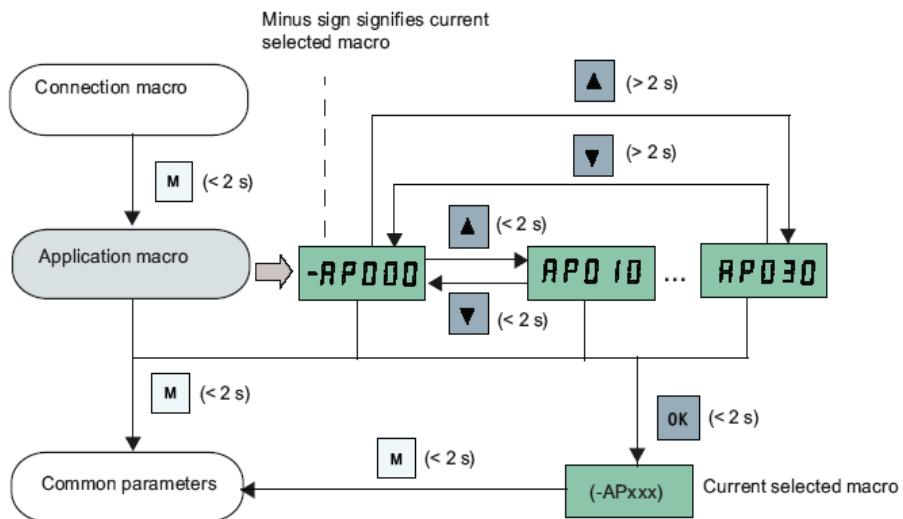
توسط کلید های جهت بالا و پایین می توانید، بین پارامترهای AP000 تا AP030 حرکت کنید. بر روی هر کدام از این پارامترها، که کلید OK را فشار دهید، آن Application برای تعیین کاربرد درایو انتخاب خواهد شد.
