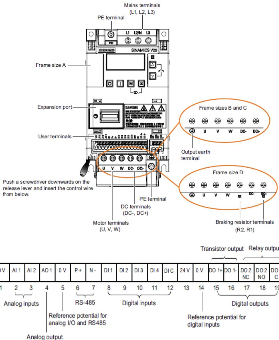
ورودی آنالوگ AI1 می تواند ولتاژهای ۰ تا +۱۰ ولت یا ولتاژهای -۱۰ تا +۱۰ را به کار گیرد. به ورودیهای آنالوگ AI1 و AI2 می توانید جریان صفر تا ۲۰ میلی آمپر و یا جریان ۴ تا ۲۰ میلی آمپر، اعمال کنید. ورودی های AI1 و AI2 هم ولتاژ و هم جریان ورودی را قبول می کنند. خروجی آنالوگ AO1 نیز جریان خروجی صفر تا ۲۰ میلی آمپر یا ۴ تا ۲۰ میلی آمپر را در خروجی ایجاد می کند.
