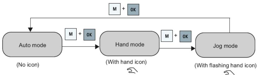
يعنى اگر درایو در حالت Auto قرار دارد، از طریق ترمینال های ورودی، کنترل می‌گردد. برای رفتن به حالت کنترل دستی (Local) یا hand (Local) باید دو کلید M و OK را با هم فشار دهید. اگر باز هم کلید های M و OK را فشار دهید وارد حالت Jog می‌شوید. برای خروج از حالت Jog و رفتن به حالت Auto، باز هم دو کلید M و Ok را همزمان فشار دهید.
