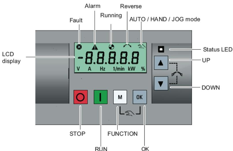
نمایشگر این درایو، دارای یک صفحه LCD سه سطحی است که در سطوح بالا و پایین ، وضعیت درایو و در سطح وسط که پنج رقمی است شماره پارامترها و مقادیر درون آن ها قابل مشاهده است . در سطح بالا از سمت راست ، کنترل به روش دستی ، جهت چرخش موتور، وضعیت حرکت یا توقف موتور ، آلام و فالت درایو را می توان مشاهده نمود. در سطح پایین از سمت راست به چپ نیز واحدهای % و RPM و A و Hz و V نمایش داده می شوند.
