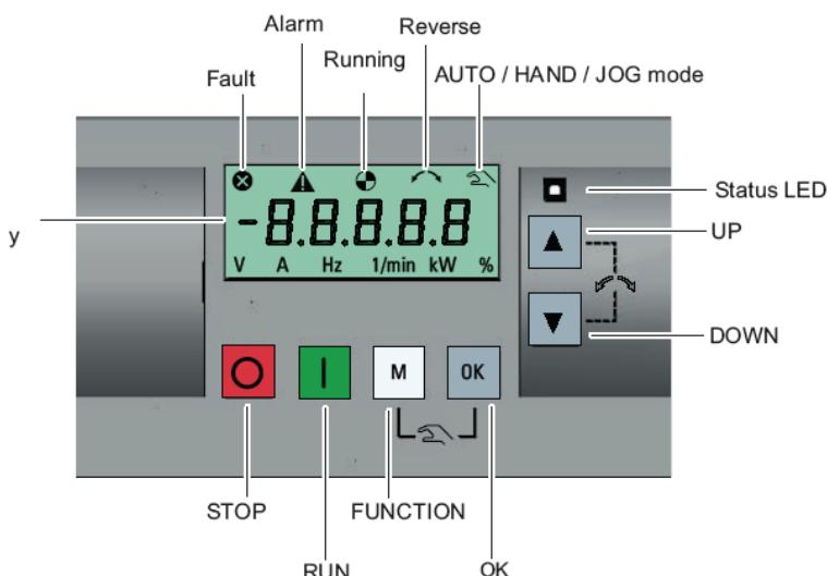
علاوه بر کی پد موجود روی درایو، از یک مدل External BOP دیگر به نام BOP نیز برای نصب بر روی درب کابینت کنترل یا با کمی مسافت از درایو، استفاده می گردد.
